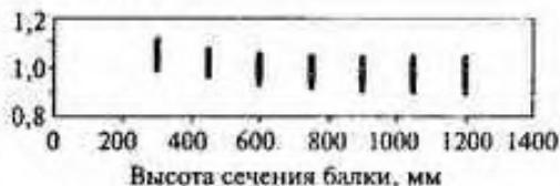
Рис. 7. Погрешность приближенной формулы для вычисления момента инерции прямоугольного сечения без трещин
